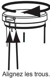
**3)** Fixez le couvercle à la base au moyen des vis fournies (quatre par couvercle).
